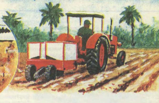
скальзывает в борозду, и особое приспособление засыпает его слоем земли толщиной в пять сантиметров... Движет посадочную машину по полю обычный трактор. А работает она в десятки раз быстрее человека.
